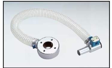
Udløserventil til forlænget styreenhed. Letter frigørelse af lasten ved brug af store sugefødder, f.eks. ved vertikale løft.
